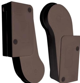
Contact à rouleau pour volets roulants, grâce à sa construction spéciale, il est capable de suivre le mouvement du volet, grâce à la tige de basculement intégrée. Le contact est équipé d'un bornier NC à 4 pôles pour la sortie d'alarme et la sortie d'autoprotection. Le contact est disponible en deux modèles : blanc ou marron.
