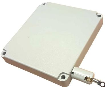
Contact de câble pour volets roulants et rideaux. La construction spéciale avec collet pivotant allongé et guide de poulie en laiton facilite l'installation et garantit une longue durée de vie du fil de nylon. Le contact est équipé de 2 bornes NF à bord, pour la sortie d'alarme.
