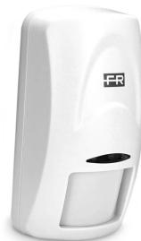
Rivelatore volumetrico DT filare da interno, per la protezione di ambienti residenziali e commerciali con copertura fino a 15 mt. Antimascheramento selezionabile. Funzionamento AND/OR. Esclusiva funzione Warning, che garantisce il funzionamento in OR esclusivo, nel caso in cui una delle due tecnologia sia mascherata o guasta. Doppia compensazione della temperatura. Pet immune fino a 20 Kg. Snodo in dotazione
