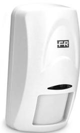
Rivelatore volumetrico DT filare da interno, per la protezione di ambienti residenziali e commerciali con copertura fino a 15 mt. Antimascheramento selezionabile. Funzionamento AND/OR. Esclusiva funzione Warning, che garantisce il funzionamento in OR esclusivo, nel caso in cui una delle due tecnologia sia mascherata o guasta. Doppia compensazione della temperatura. Pet immune fino a 20 Kg. Snodo in dotazione
