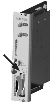
Zur Extraktion des CAM, drücken Sie die Taste Korrespondent
