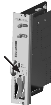
Pour extraire le module CAM, appuyer sur le bouton correspondant
