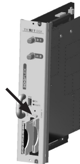
Per estrarre la CAM premere il piolino corrispondente
