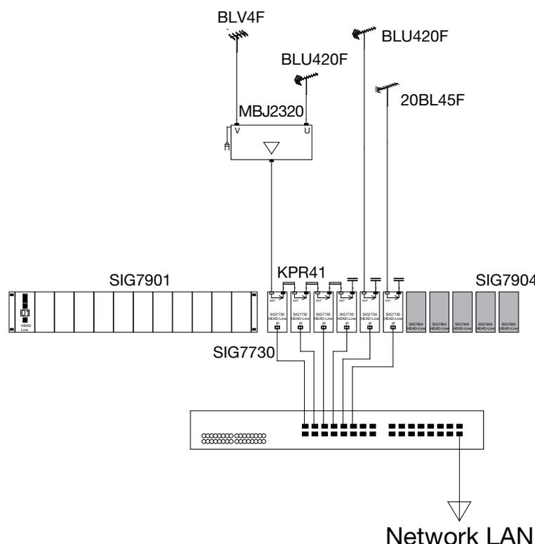
**IMPORTANTE:** a infra-estrutura deverá ser predisposta ou dimensionada de forma a suportar velocidades de fluxo equivalentes a, pelo menos, 100Mbit/s e ainda, para não congestionar o tráfego disponível, todos os aparelhos activos que comporão a rede deverão suportar o **MULTICASTING**. Esta verificação deverá ser solicitada ao administrador da rede na qual será instalado o encapsulador.
