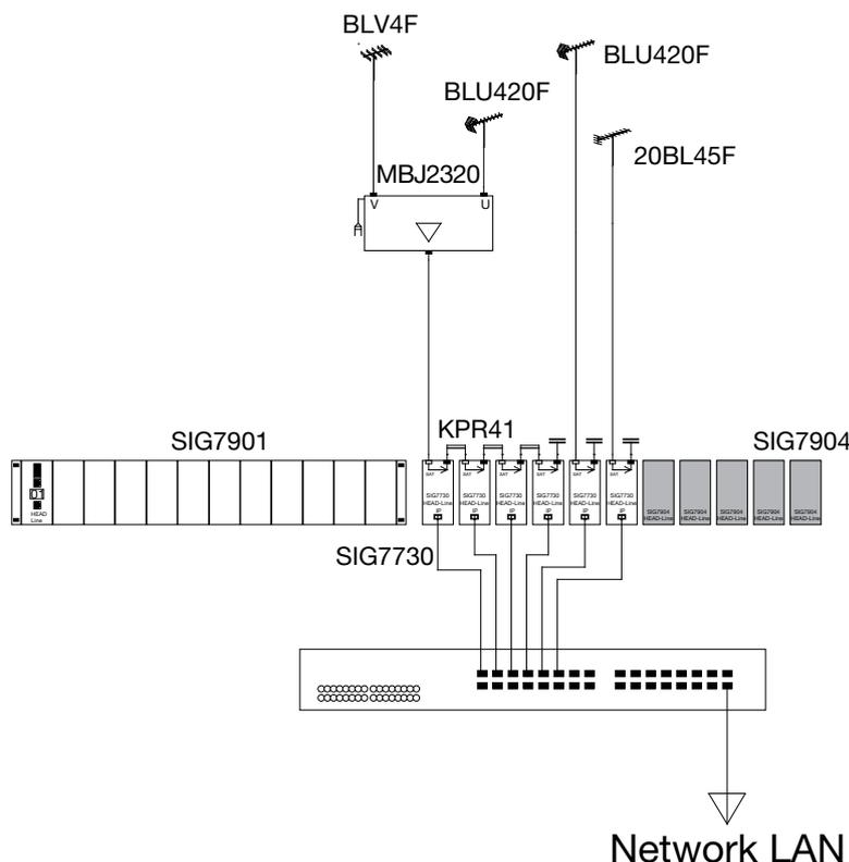
**IMPORTANTE:** l'infrastruttura dovrà essere predisposta o dimensionata in modo tale da sopportare velocità di flusso pari ad almeno 100Mbit/s, inoltre per non congestionare il traffico disponibile, tutti gli apparati attivi che comporranno la rete dovranno supportare il MULTICASTING. Tale verifica sarà demandata all'amministratore della rete dove verrà installato l'incapsulatore.
