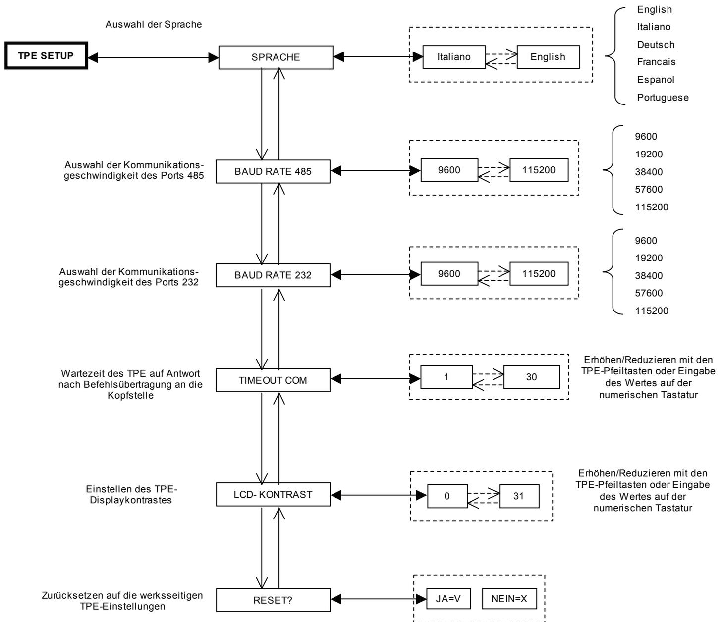
Alle Eingaben müssen mit der ✓-Taste bestätigt werden; nach Beendigung der Programmierung des Moduls/der Module müssen die Einstellungen mit der S-Taste gespeichert werden.
