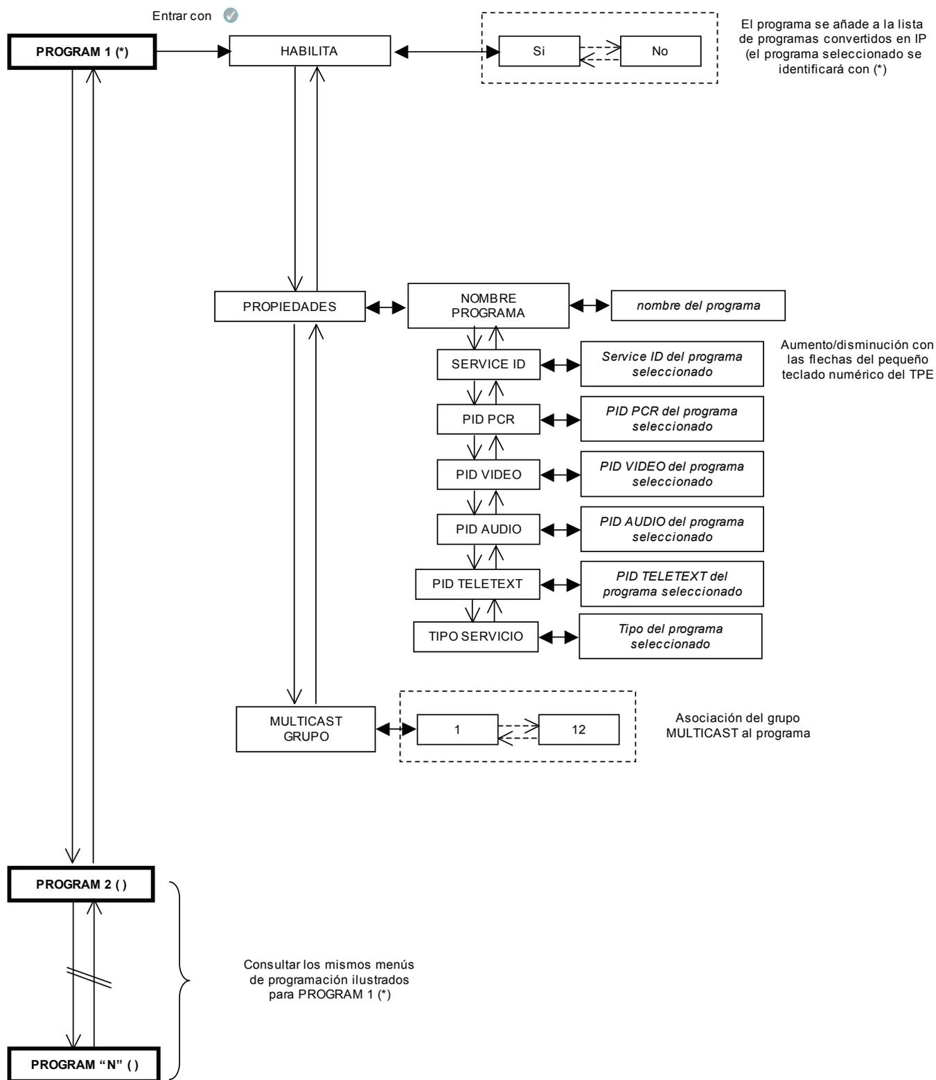
En cada ajuste se debe confirmar la selección con la tecla ✓; una vez que finalice la programación del módulo o de los módulos se deben guardar los seteos con la tecla S.
