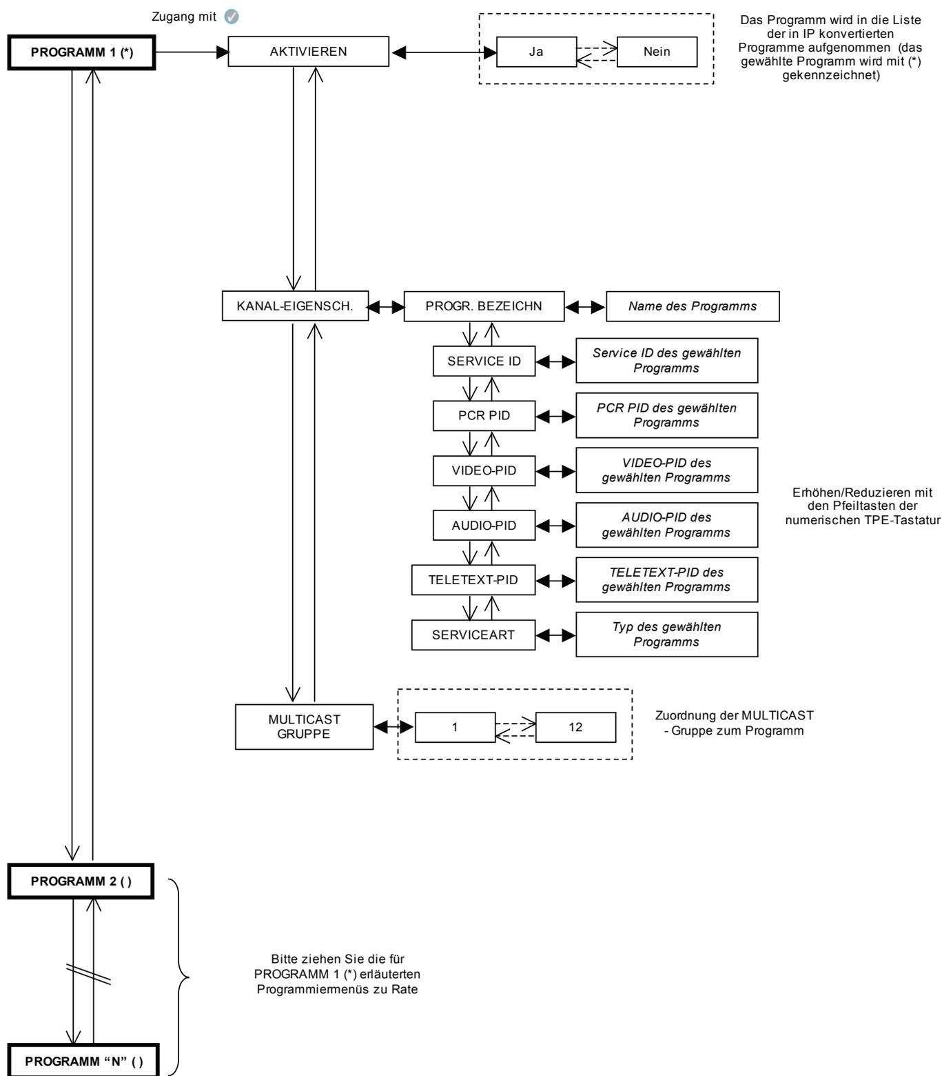
Alle Eingaben müssen mit der ✓-Taste bestätigt werden; nach Beendigung der Programmierung des Moduls/der Module müssen die Einstellungen mit der S-Taste gespeichert werden.
