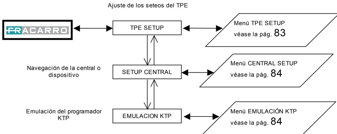
En cada ajuste se debe confirmar la selección con la tecla **✓**; una vez que finalice la programación del módulo o de los módulos se deben guardar los seteos con la tecla **S**.
