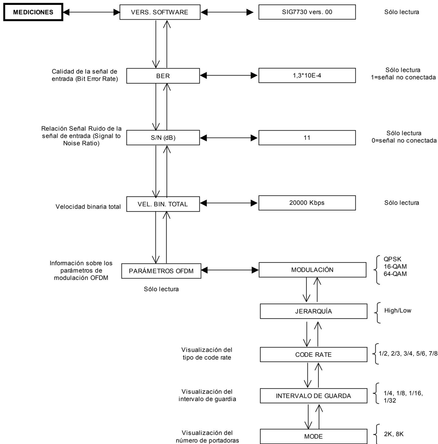
En cada ajuste se debe confirmar la selección con la tecla **✓**; una vez que finalice la programación del módulo o de los módulos se deben guardar los seteos con la tecla **S**.
