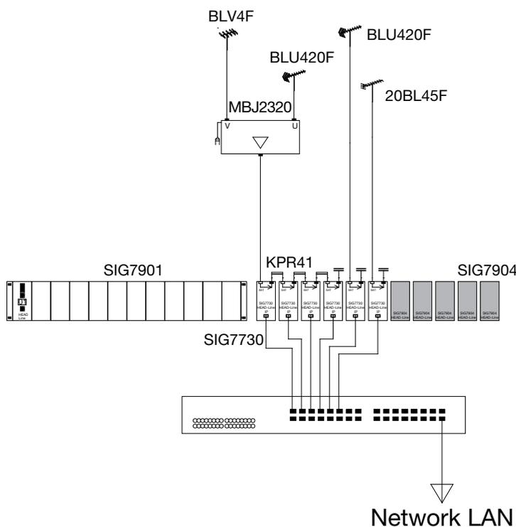
**IMPORTANTE:** la infraestructura tendrá que estar preparada o dimensionada para soportar una velocidad de flujo de 100 Mbit/s como mínimo, además para no congestionar el tráfico disponible todos los aparatos activos que formarán la red tendrán que soportar el MULTICASTING. Esta comprobación se solicita al administrador de la red donde se instalará el encapsulador.
