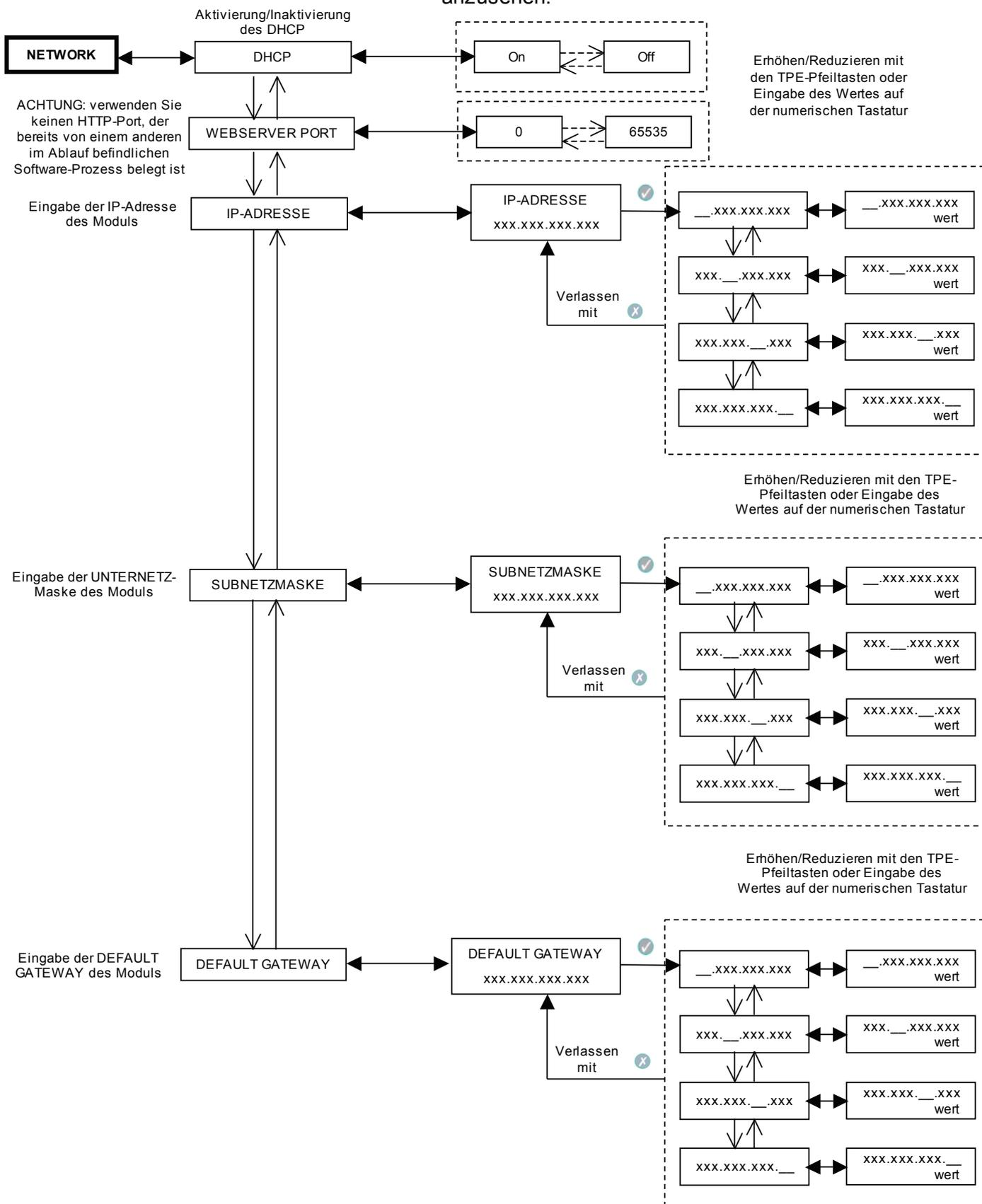
ACHTUNG: verwenden Sie keinen HTTP-Port, der bereits von einem anderen im Ablauf befindlichen Software-Prozess belegt ist
