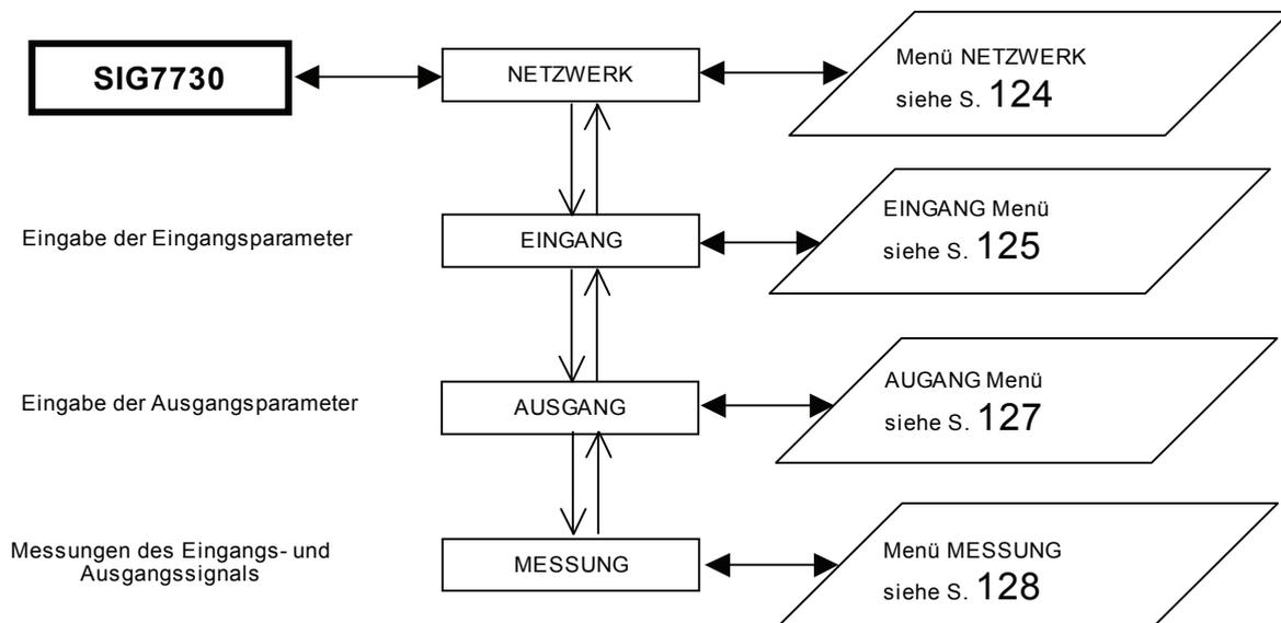
Alle Eingaben müssen mit der ✓-Taste bestätigt werden; nach Beendigung der Programmierung des Moduls/der Module müssen die Einstellungen mit der S-Taste gespeichert werden.
