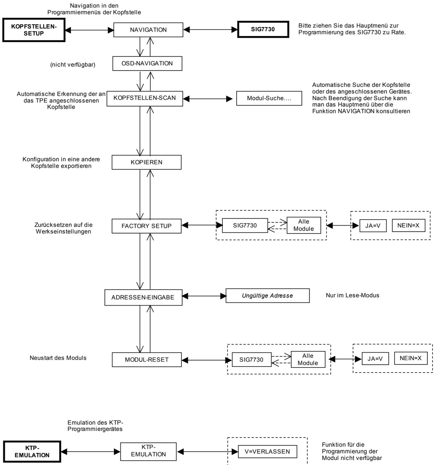
Alle Eingaben müssen mit der ✓-Taste bestätigt werden; nach Beendigung der Programmierung des Moduls/der Module müssen die Einstellungen mit der S-Taste gespeichert werden.
