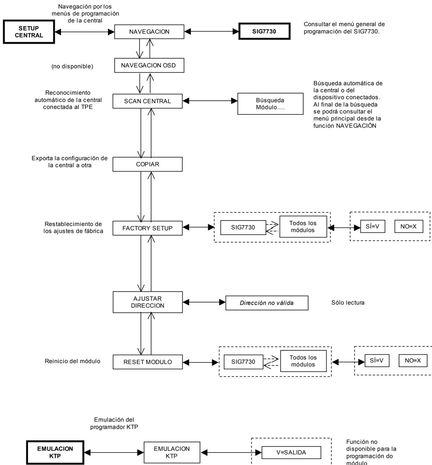
En cada ajuste se debe confirmar la selección con la tecla ✓; una vez que finalice la programación del módulo o de los módulos se deben guardar los seteos con la tecla S.
