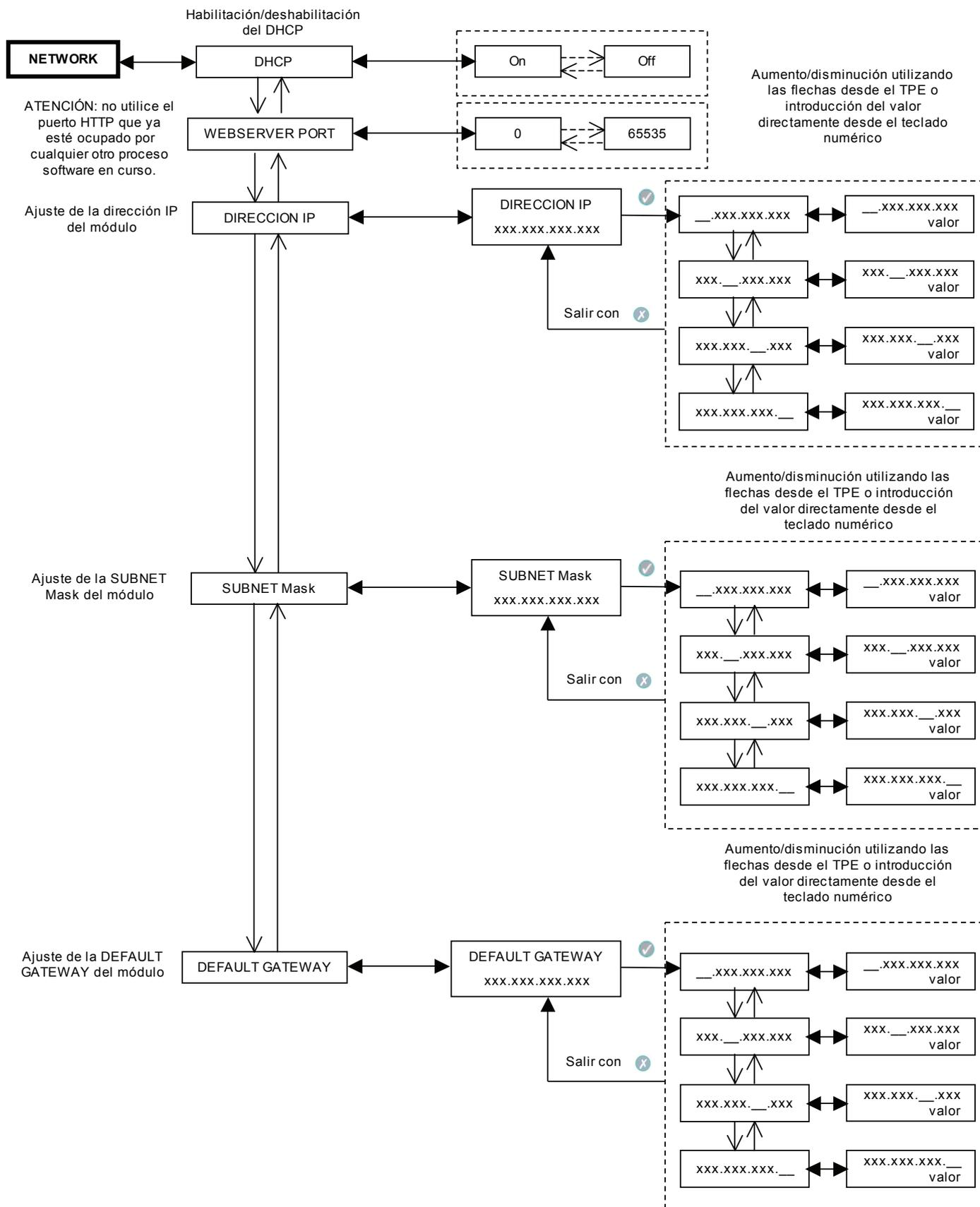
En cada ajuste se debe confirmar la selección con la tecla ✓; una vez que finalice la programación del módulo o de los módulos se deben guardar los seteos con la tecla S.
