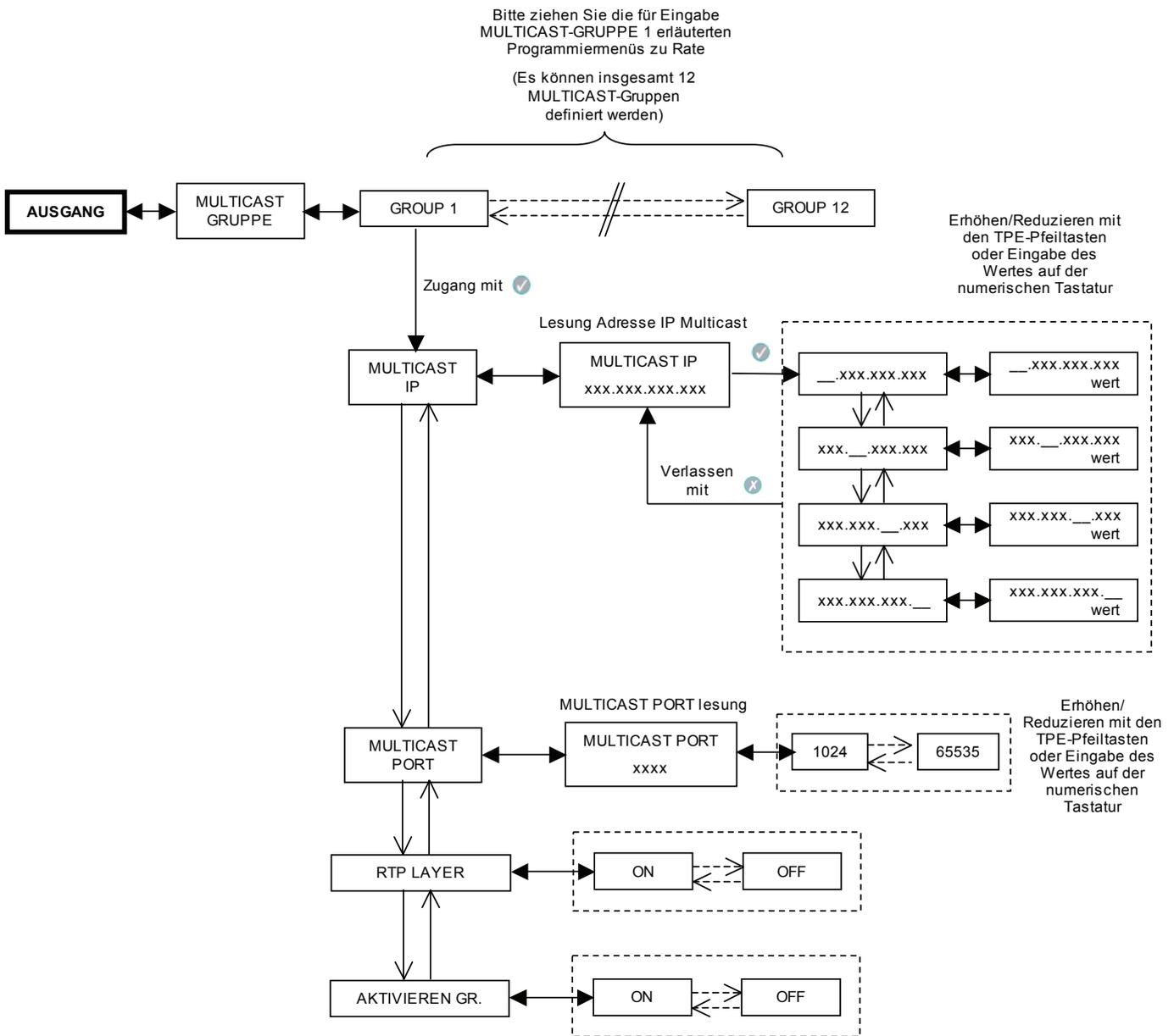
Alle Eingaben müssen mit der ✓-Taste bestätigt werden; nach Beendigung der Programmierung des Moduls/der Module müssen die Einstellungen mit der S-Taste gespeichert werden.
