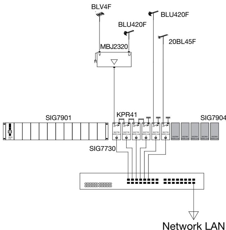
**WICHTIG:** die Infrastrukturen müssen so ausgelegt bzw. dimensioniert werden, dass Flussschwindigkeiten von mindestens 100Mbit/s möglich sind. Außerdem müssen alle zum Netz gehörenden aktiven Geräte im MULTICASTING-Modus arbeiten können, um Stockungen des verfügbaren Netzverkehrs zu vermeiden. Diese Kontrolle muss vom Administrator des Netzwerks durchgeführt werden, in dem der Kapseler installiert wird.
