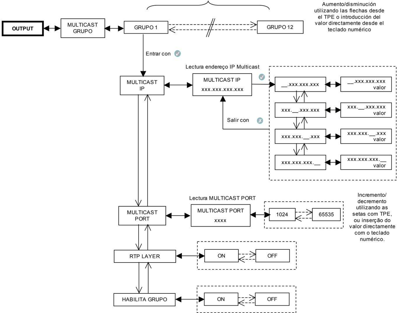
En cada ajuste se debe confirmar la selección con la tecla ✓; una vez que finalice la programación del módulo o de los módulos se deben guardar los seteos con la tecla S.
