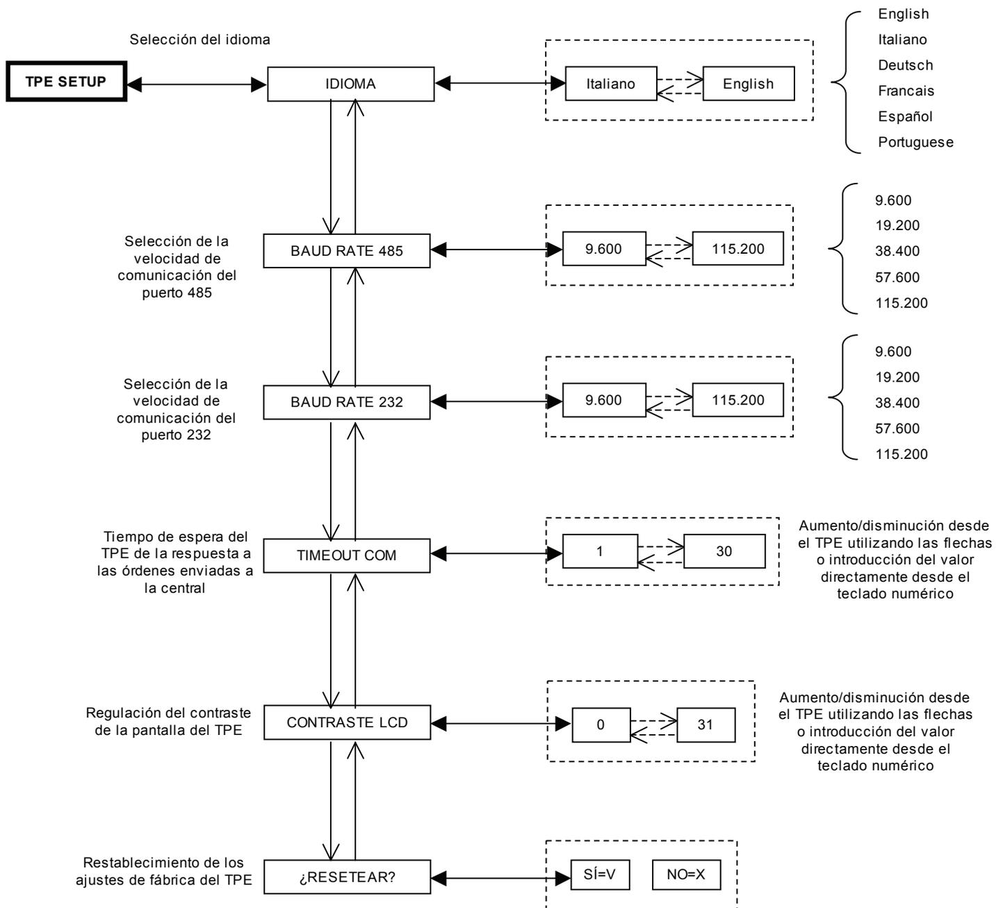
En cada ajuste se debe confirmar la selección con la tecla **✓**; una vez que finalice la programación del módulo o de los módulos se deben guardar los seteos con la tecla **S**.
