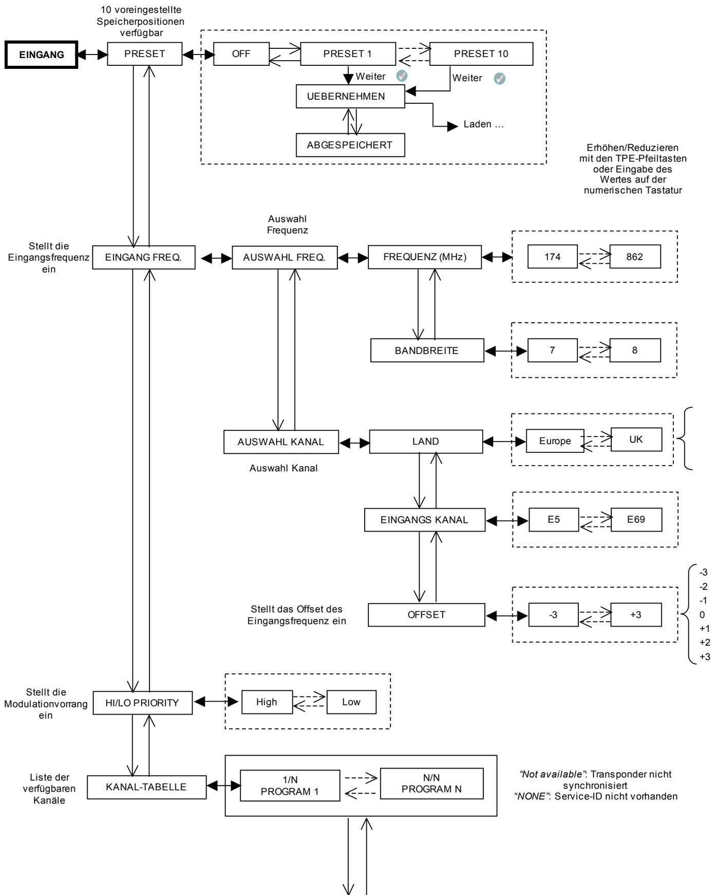
Alle Eingaben müssen mit der ✓-Taste bestätigt werden; nach Beendigung der Programmierung des Moduls/der Module müssen die Einstellungen mit der S-Taste gespeichert werden.
