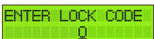
Ogni volta che la centrale uscirà dalla programmazione o verrà riavviata dopo una mancanza di alimentazione, per accedere al menu di programmazione sarà necessario inserire il codice di sblocco.
