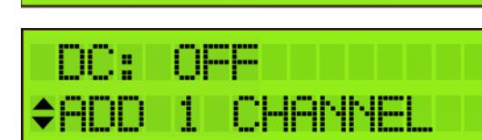
Se dovesse essere necessario utilizzare dei preamplificatori da palo, impostare in ON la telealimentazione nella sezione “**DC**”. La massima corrente disponibile è 100mA per tutti e 4 gli ingressi VHF/UHF.
