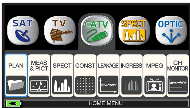
Tocca "CATV" poi "PLAN" oppure utilizza l'encoder per accedere alla lista delle canalizzazioni CATV.
