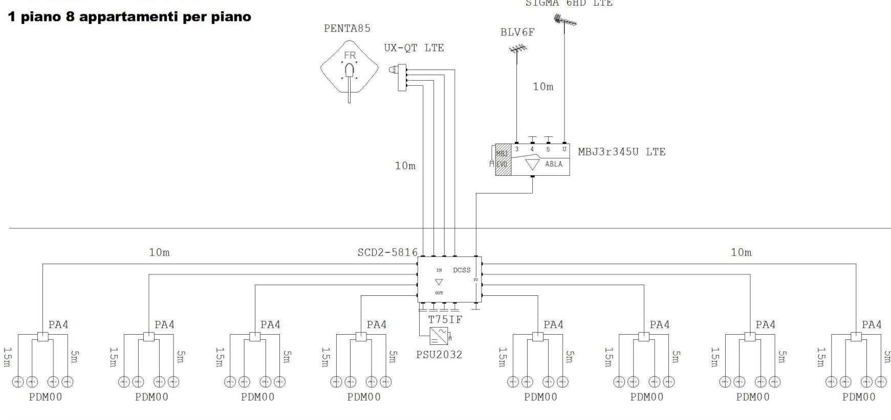
L'indicazione delle antenne, dei supporti porta-antenna e dei preamplificatori da palo nello schema è puramente indicativa, in quanto la scelta dipende esclusivamente dalla tipologia di segnale TV ricevuto nella zona di realizzazione dell'impianto e dalla struttura dello stabile.
