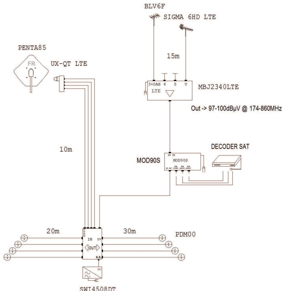
L'indicazione delle antenne e del centralino riportate nello schema è puramente indicativa in quanto la scelta dipende esclusivamente dalla tipologia di segnale ricevuto nella zona di realizzazione dell'impianto.
